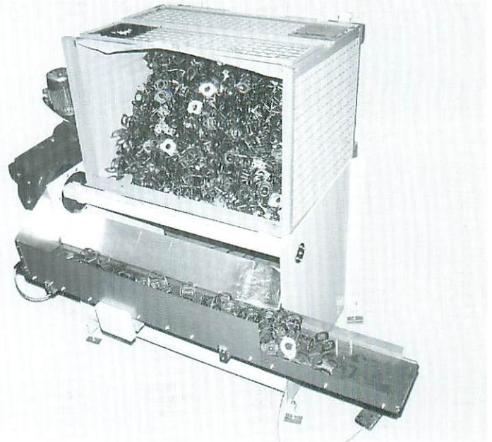
Wenn heute Teile aus einer Gitterbox entnommen und weiterverarbeitet werden müssen, ist es immer mit grossen Aufwendungen und Stillstandzeiten der Maschine verbunden. Von Hand müssen die Teile mühsam aus der Gitterbox entnommen, in einen kleineren Behälter gelegt und dann manuell an die Zuführ- oder Ladestation gebracht werden. Mit unserer **automatischen Kippvorrichtung ist dies alles viel einfacher und vollautomatisch.**
