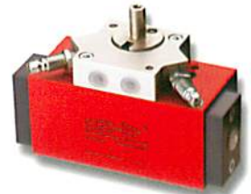
MD 32 Drehantriebe Drehwinkel bis 180°, Drehmoment bis 3,60Nm, Belastung radial bis 1100N, achsial bis 1500N.
