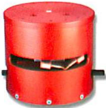
RT 200 Rundschalttisch Teilungen 2,3,4,6,8,12 und 24. Mas- sentragfähigkeit 0,2kgm'. Belastung radial bis 800N, axial 1000N.
