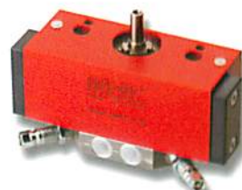
MD 20 Drehantriebe Drehwinkel bis 180°, Drehmoment bis 1,10Nm, Belastung radial bis 350N, achsial bis 300N.
