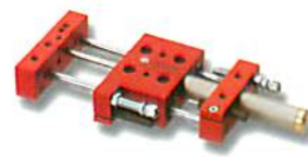
ML 13 Minilineareinheit Hub bis 100mm, Kolbenkraft 32N, Tragkraft bis 196N.
