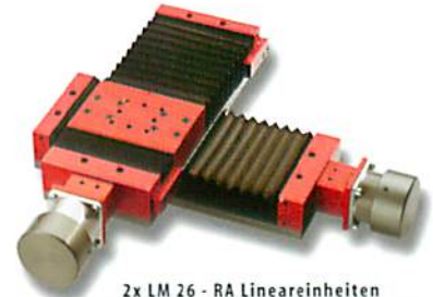
2x LM 26 - RA Lineareinheiten Elektrisch angetriebene Einheiten in Kombination als Kreuztisch mit spielfreier Schienenführung. Hub bis 400mm, Tragkraft 750N.
